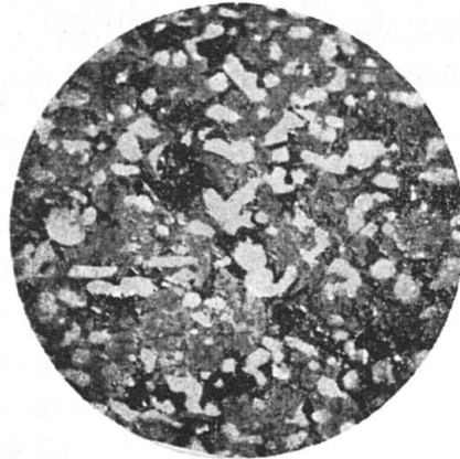
Fig. 11. Anschliff A 4. Windgepackter Schnee, senkrecht Schichtfläche. Windrichtung = Zeilenrichtung v. r. n. l.
