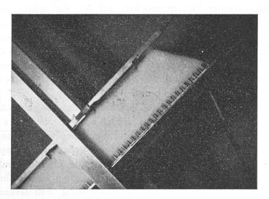
Fig. 1. Schneeprobe 2 im Scherapparat unter ihrem Eigengewicht in 14 Tagen deformiert.  $T=-3^{\circ}$  (Tafel aus der natürlichen Schneedecke rechtwinklig ausgestochen).
