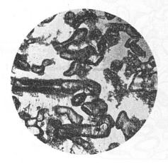
Fig. 7. Dünnschliff D 2c, senkrecht zur Scherfläche. Scherrichtung = Zeilenrichtung. 15:1
