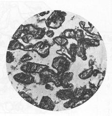
Fig. 8. Dünnschliff D2b, parallel zur Scherfläche. 15:1
