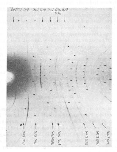
Fig. 4. Drehaufnahme eines Maucherit-Kristalls. Drehachse [001]. Daten wie vorher.
