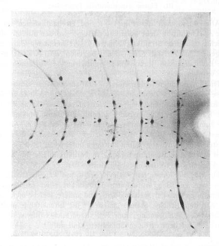
Fig. 1. Drehkristallaufnahme eines "Wurtzit"-Kristalls. Drehachse [0001],  $CuK_{\alpha}$  (streng monochromatisch). Indizierung der Reflexe siehe Fig. 1 a, b.
