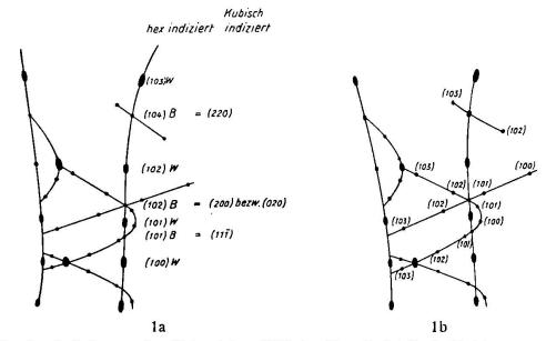
Fig. 1a. Indizierung des Gitterstabes (101) des Hauptkristalls (schief-hexagonale Aufstellung). Wurtzitreflexe wurden mit (101)<sub>w</sub>, Zinkblendereflexe mit (101)<sub>B</sub> bezeichnet. Für die Blendereflexe wurde rechts davon die Indizierung in kubischer Aufstellung angegeben.
