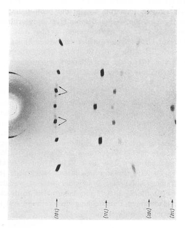
Fig. 3. Drehaufnahme eines Graphitkristalls. Drehachse [0001], Aufnahmedaten wie Fig. 1.
