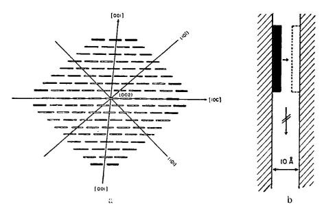
Fig. 6. a) Querschnitt durch einen kristallinen Zellulosestrang. Schwarz: an der Oberfläche adsorbierte Kongorotmoleküle im Querschnitt. b) Eine 10 Å weite Lücke im Kettengitter der Zellulose. Die absorbierten Kongorotmoleküle (schwarz) können nur senkrecht zur Faserrichtung wandern!
