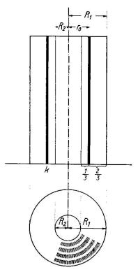
Fig. 2. Hohlzylinder mit radiärer Anordnung der optisch einachsigen Bauelemente bei maximaler Kompensation.  $R_1$  = Radius des Hohlzylinders,  $R_2$  = Radius des Hohlraumes,  $r_0$  = variabler Abstand des Kompensationsstreifens, k = Lage des Kompensationsstreifens bei maximaler Kompensation ( $\Gamma_{max}$ )
