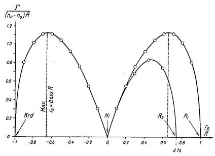
Fig. 1. Gangunterschied  $\Gamma$  eines Sphäriten in Funktion von  $r_0$  ( $r_0$  = Abstand vom Sphäritenzentrum, Hi = Hilum, Krd = Kornrand). Rechts: Der Gangunterschied einer Hohlkugel vom Radius  $R_1$  = 1 und einem Hohlraum vom Radius  $R_2$  = 0,75 ist gegeben durch die Differenz der beiden angegebenen Kurven; vgl. Formel (3)
