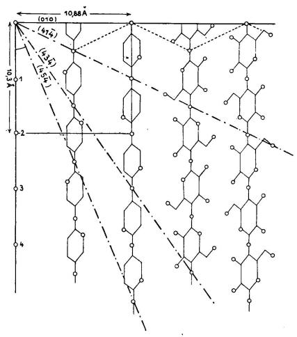
Fig. 7b. Hydrolyseebenen im Kettengitter der Zellulose
