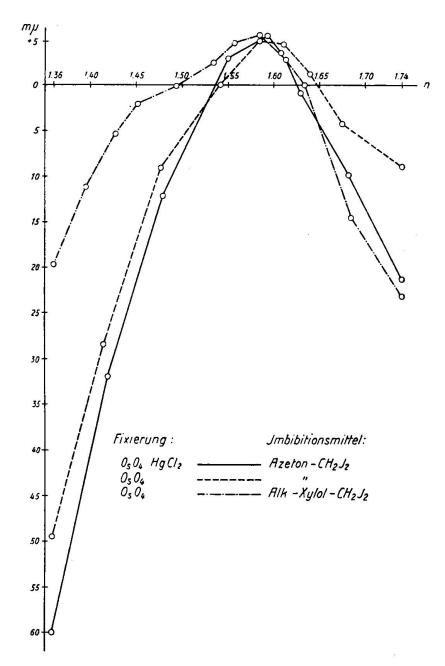
Fig. 4. Schichtendoppelbrechungskurven der Chloroplasten von Mougeotia. Ordinate: Gangunterschied in mμ. Abszisse: Brechungsindex n<sub>2</sub> des Imbibitionsmittels
