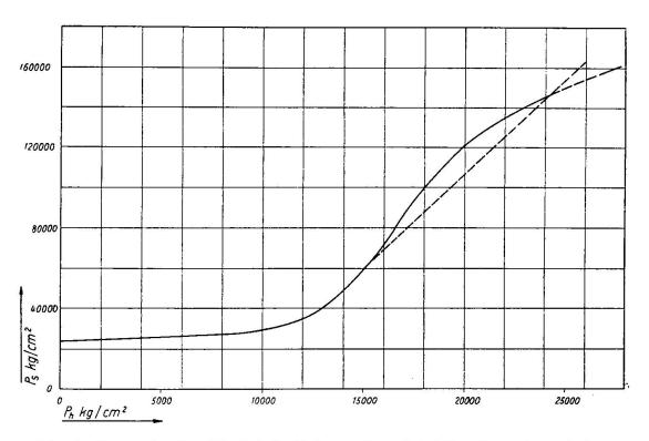
Fig. 1. Kurve der Bruchfestigkeit (Ps) von Quarzkristallen längs der c-Achse nach Experimenten von Sosman, Griggs und Bridgman in Abhängigkeit vom hydrostatischen Umgebungsdruck (Ph). Die Kurve ist bei höheren Drucken nicht genau festgelegt (entweder ungefähr wie die ausgezogene Linie oder wie die gestrichelte Linie), weil die Messgenauigkeit in diesen Druckbereichen gering ist und die Resultate von verschiedenen Autoren stammen.
