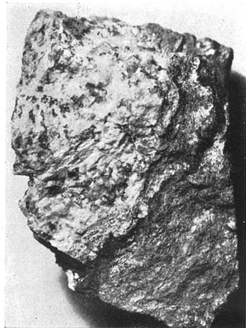
Fig. 5. Kontakt des Spodumenpegmatites mit Injektionsgneis, Villatuje. Ca. \frac{2}{3} natürlicher Grösse
