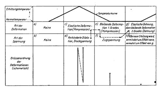
Fig. 4. Beispiel für thermisch bedingte Stress-Strain-Beziehungen, schematisch dargestellt. Die Pfeile deuten die Abhängigkeitsfolge an. Erläuterung im Text.
