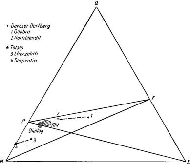
Fig. 4. QLM-Projektion. Die Gabbrogesteine liegen ziemlich genau auf der Geraden Feldspat (F) - Diallag (bzw. Aktinolith). Vergleichsweise sind Gesteine des Totalpserpentins eingetragen
