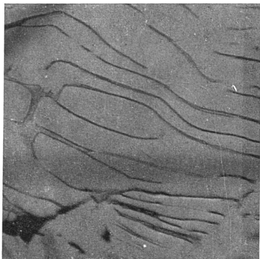
Fig. 1. Haarförmige Flüssigkeits-Kanäle in Turmalin, 250 \times
