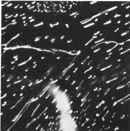
Fig. 3. Typische Fahne, Flüssigkeits- Tröpfchen in Ceylon-Saphir, 250×
