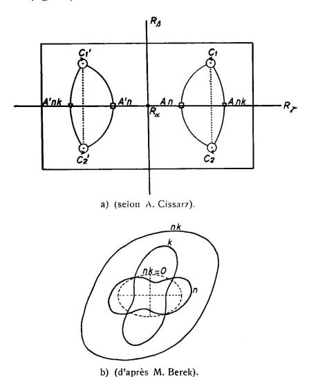
Fig. 2. a) Axes de torsion. b) Courbes d'intersection des indicatrices complexes avec le plan des axes principaux a et c dans le système monoclinique
