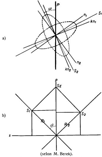
Fig. 6. a) Ellipticité de la vibration des rayons  $S_1$  et  $S_2$  en incidence normale sur un minéral absorbant anisotrope de symétrie inférieure. b) Décomposition des composantes complexes  $S_1$  et  $S_2$ , suivant les deux directions perpendiculaires des nicols p et s
