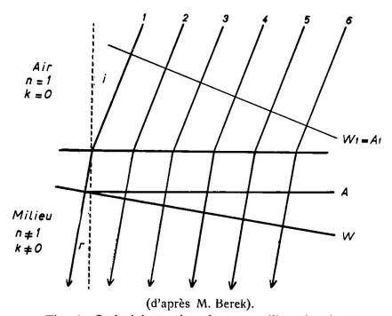
Fig. 1. Onde inhomogène dans un milieu absorbant
