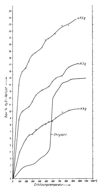
Fig. 2. Entwässerungskurven von synthetischen Serpentin-Gelen, welche durch Reaktion von Alkalisilikat- mit Magnesiumsalz-Lösungen hergestellt wurden. Zum Vergleich ist die Entwässerungskurve von natürlichem Chrysotil eingezeichnet
