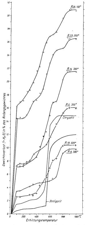
Fig. 1. Entwässerungskurven von aus den Oxyden synthetisch hergestellten Serpentin-Gelen. Die einzelnen Kurven sind durch die Versuchsnummern gekennzeichnet (vergl. Tabelle 2). Ferner ist bei jeder Kurve die Bildungstemperatur des betr. Geles angegeben. Zum Vergleich sind ferner die Entwässerungskurven der natürlichen Serpentinmineralien Chrysotil und Antigorit eingezeichnet
