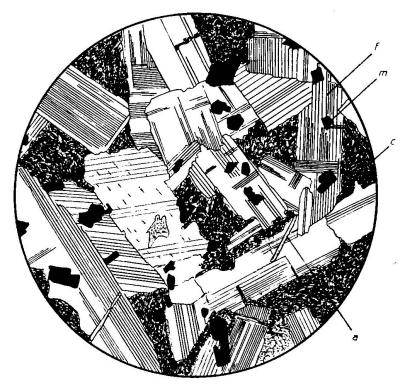
Fig. 4. Diabase intersertale albitochloritique du Pays d'Enhaut. f = albite, c = chlorite, m = minéral opaque, a = apatite. Gross.: 18  $\times$ .
