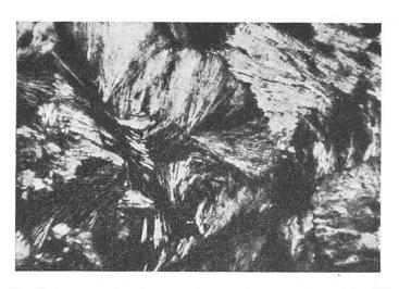
Fig. 12. Bel exemple de structure arborescente-sphérolitique. Diabase du Col des Gêts. Haute Savoie. Nicols croisés. Gross.: 65 ×.
