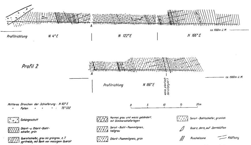
Fig. 1. Detailprofile durch das permokarbonische Marmorvorkommen "Am Biel" bei Realp (Urserental)
