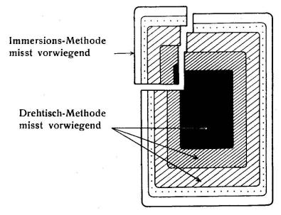
Fig. 3. Zonares Plagioklaskorn mit abgetrenntem Spaltstück
