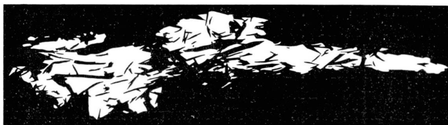
Fig. 2. Grössere Erzpartie (Pentlandit) stark von feinsten Antigoritblättchen (schwarz) durchwachsen. Vergr. 60fach.
