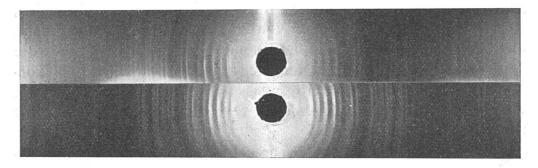
Fig. 5. Pulveraufnahmen von filzigem Turmalin von Işikdağ (oben) und hellgrünem Turmalin vom Campolungo (unten). (Cu, K<sub>a</sub>-Strahlung; Belichtungszeit: 3 Stunden).
