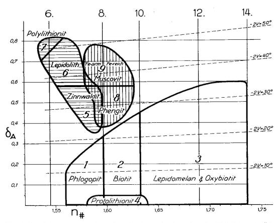
Fig. 1. Beziehungen zwischen den Brechungsindices der Spaltblättchen  $(n\frac{||}{||})$  und der Zentraldistanz der optischen Achsen in Bruchteilen des Radius des Gesichtsfeldes im Konoskop bei Benützung eines Objektives mit der numerischen Apertur  $(\delta_A)$ .
