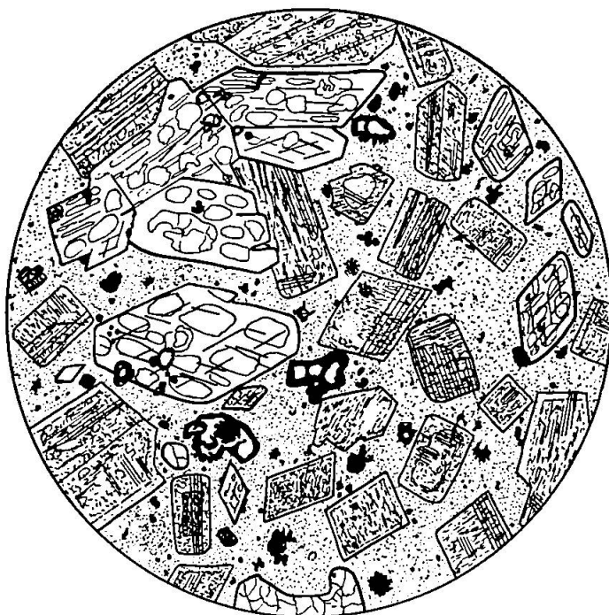
Fig. 5. Porphyrite andésitique felsitique de la Berte. Type I/3c.
