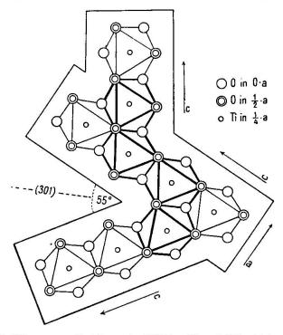
Figur 16. Drilling von Rutil nach (301). Brookitähnliche Struktur der Berührungszone
