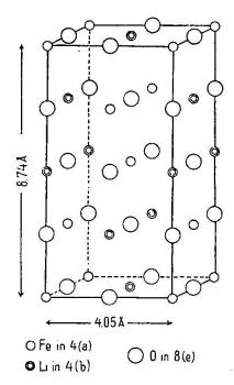
Figur 11. Elementarzelle des tetragonalen Lithiumferrits
