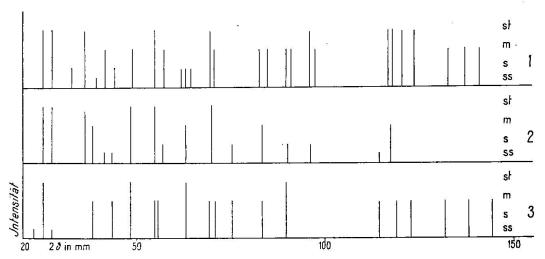
Figur 3. 2  $\vartheta$ -Werte und geschätzte Intensitäten der PKCu 120-Aufnahmen von: 1. TiO<sub>2</sub> 900 ° (Rutil), 2. TiO<sub>2</sub> 880 ° (Rutil + Anatas), 3. TiO<sub>2</sub> 700 ° (Anatas)
