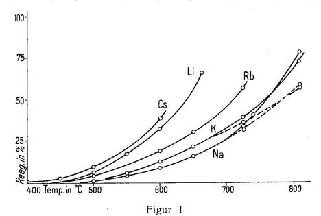
Reaktionen  $R_2CO_3 + 2 \text{ Ti }O_2 \rightarrow R_2\text{Ti}_2O_5 + CO_2$ ; Ausgezogene Kurven: Reaktion mit Anatas und R = Li, Na, K, Rb, Cs, Gestrichelte Kurven: Reaktion mit Rutil und R = Na, K.
