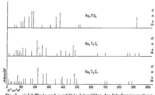
Fig. 7. sin² θ-Werte und geschätzte Intensitäten der Interferenzensysteme der Natriumtitanate Na<sub>2</sub>TiO<sub>3</sub>, Na<sub>2</sub>Ti<sub>2</sub>O<sub>5</sub>, Na<sub>2</sub>Ti<sub>3</sub>O<sub>7</sub>.
