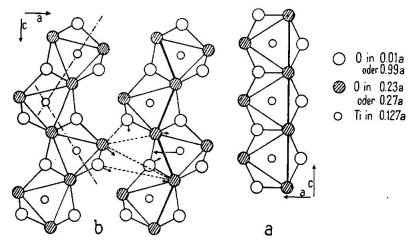
Figur 15. Bildung einer Oktaederkette von der Art des Rutils in Richtung der c-Achse des Brookits
