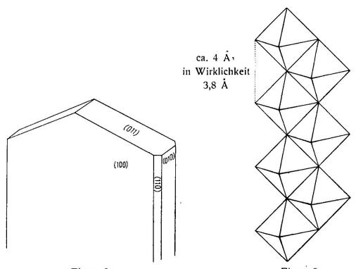
Figur 8. Nadelspitze eines Na<sub>2</sub>Ti<sub>2</sub>O<sub>5</sub>-Kristalls
