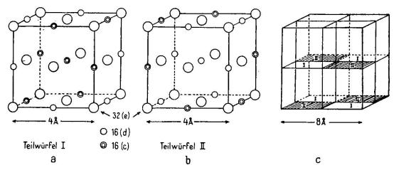
Figur 10. Punktlagen der Raumgruppe  $O_h(7)$  (Nullpunkt um 3/8 3/8 verschoben). a und b Teilwürfel; c Anordnung der Teilwürfel in der Zelle  $2a_w$ .
