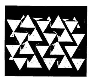
Figur 12. Strukturmodell des Brookits. Aufbau aus TiO<sub>6</sub>-Oktaedern als idealisierten Koordinationspolyedern\*)
