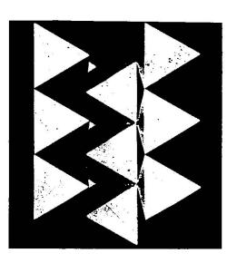
Figur 13. Strukturmodell von Rutil. Aufbau aus TiO<sub>6</sub>-Oktaedern als idealisierten Koordinationspolyedern\*)
