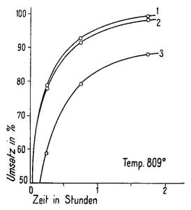
Figur 5. Umsatzbeträge der Reaktion:  $Na_2CO_3 + 2 TiO_2 = Na_2Ti_2O_5 + CO_2$ Kurve 1 für Titandioxyd (700°) = Anatas Kurve 2 für Titandioxyd (880°) = Anatas + Rütil Kurve 3 für Titandioxyd (900°) = Rutil
