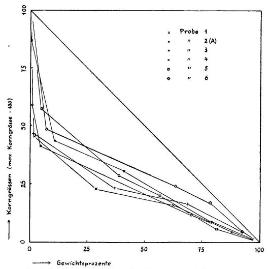
Fig. 1. Graphische Darstellung der Korngrössenverteilung der untersuchten Proben auf Grundlage der a-Linien der Tabelle 1. Kumulativprozente; maximale Korngrösse = 100.
