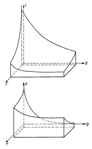
Fig. 2. Widerstand und DK des Eises nach WINTSCH R Widerstand,  $\varepsilon$  DK,  $\nu$  Frequenz, T Temperatur
