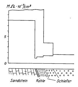
Fig. 13. Widerstände eines Kohleflözes Ordinate: spezifische Widerstände
