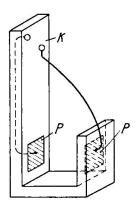
Fig. 7. Messelektrode K Klemmen, P Platinplatten
