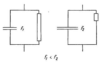
Fig. 5. Einfluss der Durchfeuchtung f Durchfeuchtung in mg/cm<sup>3</sup>
