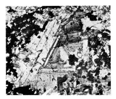
Fig. 4. Titanklinohumit (aus Mikrobreccie) mit polysynthetischer Zwillingslamellierung. Schwarz: Magnetit. Moräne Allalingletscher. Vergr. ca. 100-fach. Nicols +.
