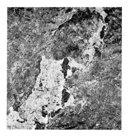
Fig. 1. Olivingang (hell) mit reichlich grossen Körnern (schwarz) von Titanklinohumit. Steinbruch Selva. Polierte Platte, ca.  $^{1}/_{5}$  der natürl. Grösse. Geaderte Serpentine mit braunrotem Titanklinohumit sind poliert von prachtvoller dekorativer Wirkung.
