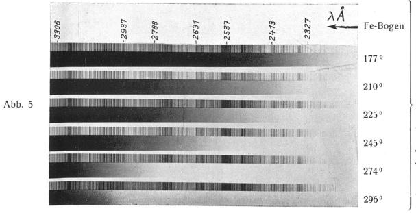
Apsorptions-Spektren der Einzelfraktionen der Hochvakuum-Destillation (Dampfspektren)
