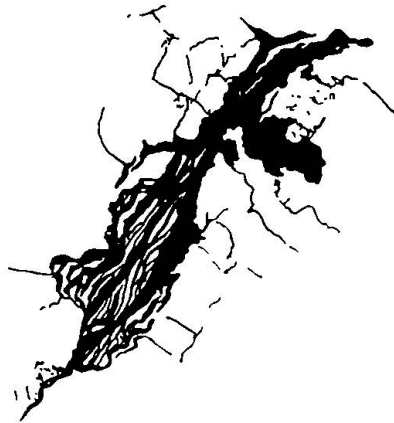
Fig. 3. In feine Lamellen aufgeblätterter Graphit mit zwischengelagerten Muskowitneubildungen.
