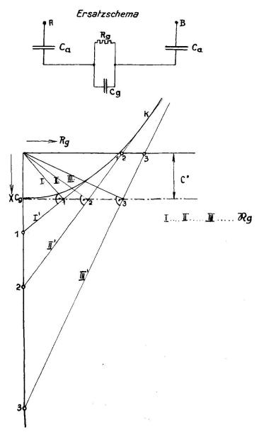
Abb. 4 c. Messung der elektrischen Eigenschaften des Untergrundes nach der sog. "Kapazitätsmethode"
