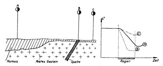
Abb. 10. Antennenersatzkapazitätskurven in der Umgebung einer Spalte
