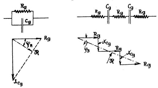
Abb. 4 a. Ersatzschema und Vektor-Abb. 4b. Ersatzschema und Vektordiagramm eines geologischen Leiters. diagramm
