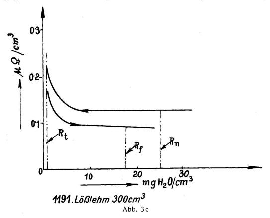
dem keine Flüssigkeit mehr anhaftet. Praktisch werden wir uns mit einem Trockenwiderstande begnügen müssen, den wir erhalten, wenn wir das Mineral bei ca. 60 ° C. solange austrocknen, bis sein Gewicht praktisch konstant bleibt. Aus der Abbildung 2 können wir schliesslich noch die sog. "relative Widerstandsänderung" ablesen. Sie gibt die Steigung der Kurve  $\Delta R/\Delta f$  im steilsten Teile an. In der Tafel I sind einige praktisch gemessene Werte zusammengestellt.
