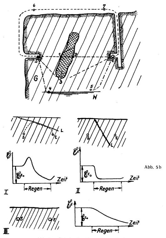
Abb. 5 a. Prinzip der Absorptionsmethode Abb. 5 b. Einfluss einer wasserführenden Spalte auf die Ausbreitung Hertzscher Felder
