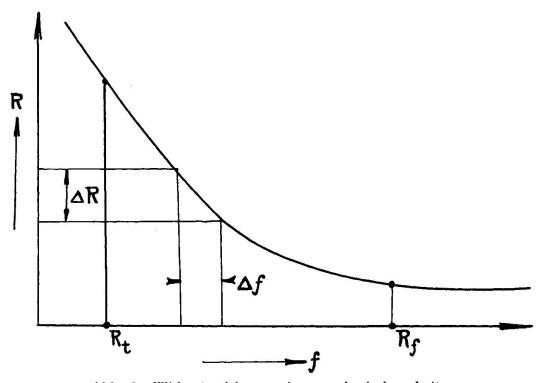
Abb. 2. Widerstandskurve eines geologischen Leiters
