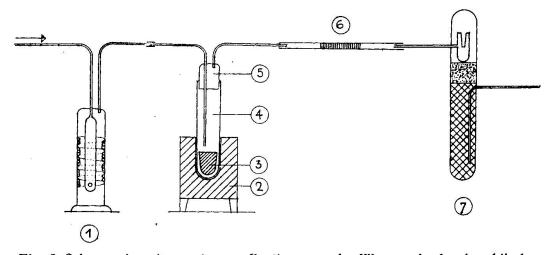
Fig. 2. Schema einer Apparatur zur Bestimmung des Wassers in den Amphibolen.
