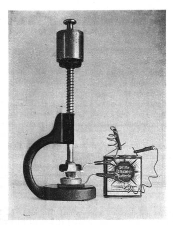
Fig. 1. Dispositif expérimental utilisé pour l'attaque électrolytique de minerais compacts
