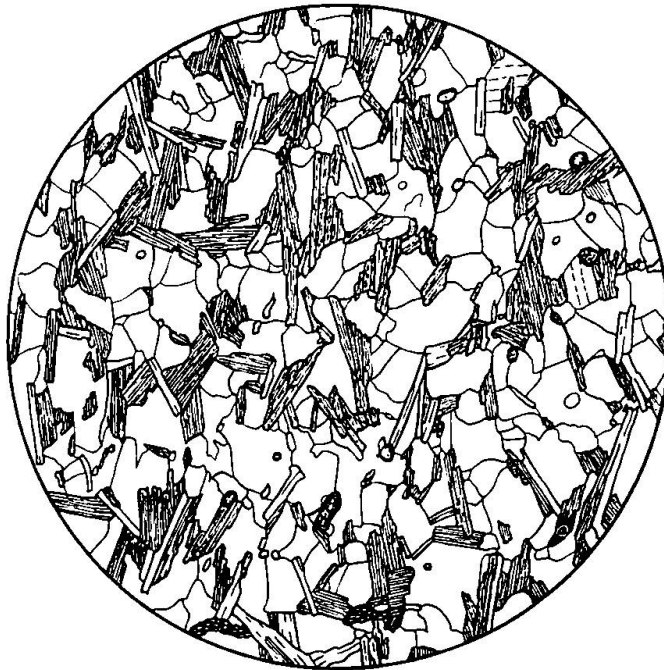
Fig. 2. Biotithornfelsgneis mit Hornfelsstruktur, vom Monte Tamaro. Die Bestandteile sind: Biotit, Muscovit, Plagioklas, Quarz (die beiden letztern nicht unterscheidbar im Orthoskop), Apatit, Granat und Zirkon. Vergr. 40\times , ohne Analysator.
