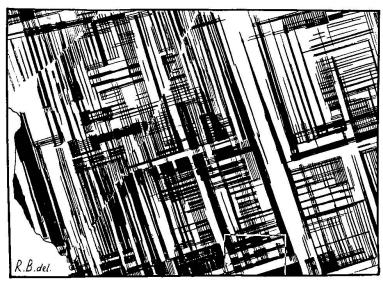
Fig. 1. Mikroklin, Schnitt senkrecht zu beiden Lamellensystemen (ungefähr parallel zur Basis). × Nicols, Vergr. 53×. NNW gerichtet Periklin-lamellen, Verwachsungsfläche (15.0.2), senkrecht dazu Albitlamellen, Verwachsungsfläche (010). Eingerahmtes Rechteck am unteren Bildrand in Fig. 2 und 3 vergrössert dargestellt.
