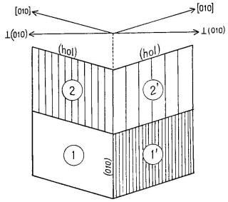
Fig. 7. Doppelzwilling nach dem Albit- und Periklingesetz in einem typisch triklinen Fall. (010) = Spur der Verwachsungsfläche,  $\perp$ (010) = Zwillingsachse des Albitgesetzes; (h0l) = Spur der Verwachsungsfläche, [010] = Zwillingsachse des Periklingesetzes.
