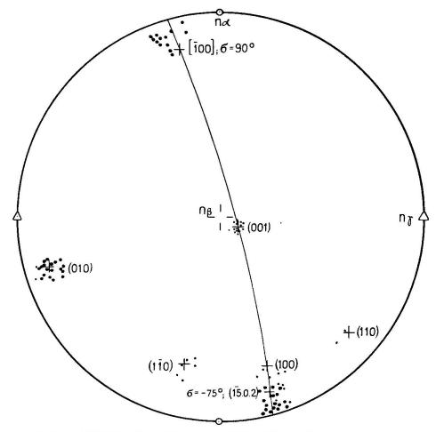
Fig. 4. Fedoroff-Nikitin Projektion des Mikroklins. Projektionsebene  $\perp$  n  $\beta$ . Kleine Punkte: Pole der gemessenen Spaltflächen. Grosse Punkte: Pole der gemessenen Zwillingsverwachsungsflächen. Kleine Kreuze: aus dem Stereogramm von Nikitin übernommene Pole.
