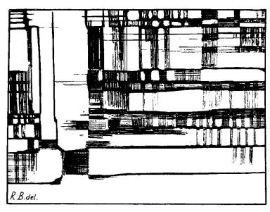
Fig. 3. Wie Fig. 2. Verwachsungsflächen nach dem Albit- und Periklingesetz parallel zu den Nicols-Hauptschnitten (0 ° Stellung).
