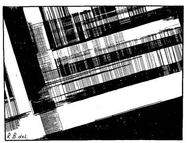
Fig. 2. Eingerahmtes Rechteck von Fig. 1. × Nicols, Vergr. 365 ×. Die groben Lamellen lösen sich z. T. auf in feinste Linien und Gittersysteme.
