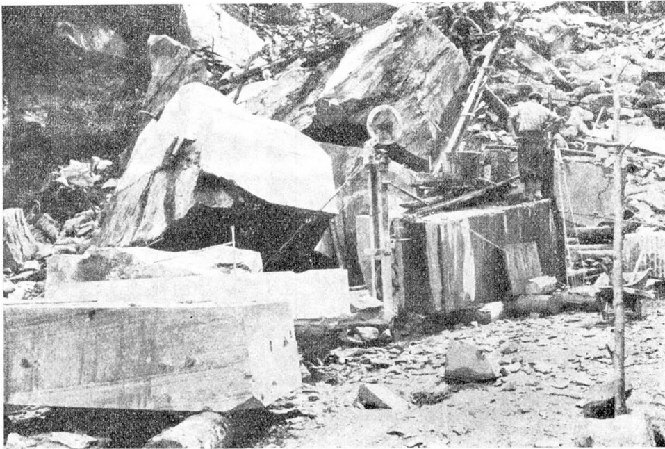
Fig. 2. Zersägen der Serpentinblöcke im Steinbruch mit Stahldrahtsägen.
