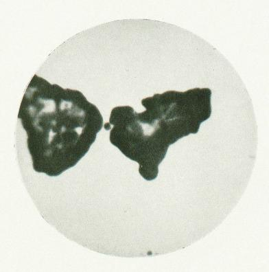
Fig. 2. — Microphotographie (G=20×) de l'empreinte des deux grains de cuivregris. Cette empreinte est vert-noir pour le cuivre et rose-rouge pour l'antimoine. (La photographie a été inversée pour permettre une meilleure comparaison avec celle de la surface polie.)
