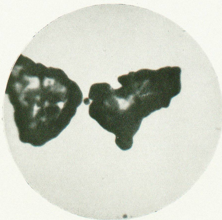
Fig. 2. — Microphotographie ( G = 20\times ) de l'empreinte des deux grains de cuivre-gris. Cette empreinte est vert-noir pour le cuivre et rose-rouge pour l'antimoine. (La photographie a été inversée pour permettre une meilleure comparaison avec celle de la surface polie.)
