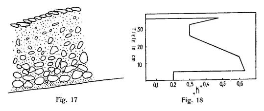
zontale Wasserwalze obengehalten werden. Dadurch tritt eine Entmischung bezw. Aufbereitung des vom Flusse herantransportierten Geschiebes ein.
