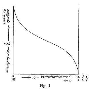
Zweckmässig ist es, die normierten Fraktionsintervalle durch Horizontalen zu markieren und die wirklichen Bestimmungen durch Punkte zu kennzeichnen. Die Punkte sind stets durch gerade Linien zu verbinden. In Dreiecksdarstellungen lassen sich bei Kiesen die Gewichtsprozentanteile der Grob- und Feinkiesfraktion neben Sand + Schluff, in Sanden dagegen von Grob- und Feinsand neben Schluff zur Darstellung bringen (siehe die Figuren in der Arbeit von ZINGG).
