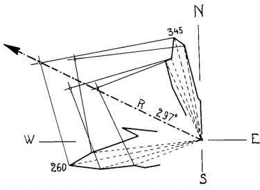
Fig. 4. Détermination de la direction primitive de mouvement à l'aide de la statistique des joints (voir fig. 1).
