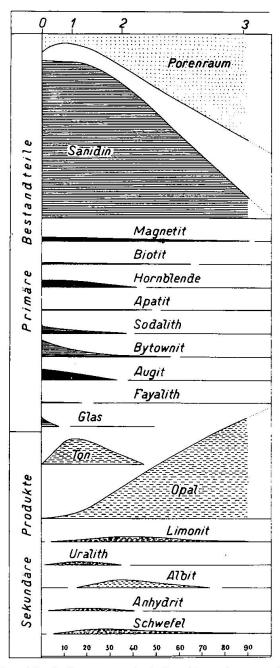
Fig. 2: Die modalen Veränderungen bei der Zersetzung. Ordinaten: Volumprozent der einzelnen Bestandteile. Abszissen: Prozentueller Gesamtverlust der primären Mineralien. (Der Masstab ist gleich für beide Koordinaten.)
