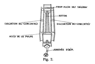
Il est inutile d'envisager l'emploi d'appareils à agitation mécanique, d'entretien et d'installation plus onéreux. Une agitation pneumatique donne des résultats satisfaisants avec notre minerai.
