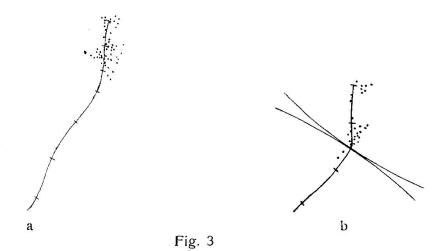
Streuung der Pole sämtlicher gemessener Karlsbader Zwillinge. a = Gemessene Pole der Verwachsungsflächen auf der Kurve 010 (Tafel 2). b = Aus der Optik konstruierte Pole der Zwillingsachsen auf der Kurve [001] (Tafel 5).
