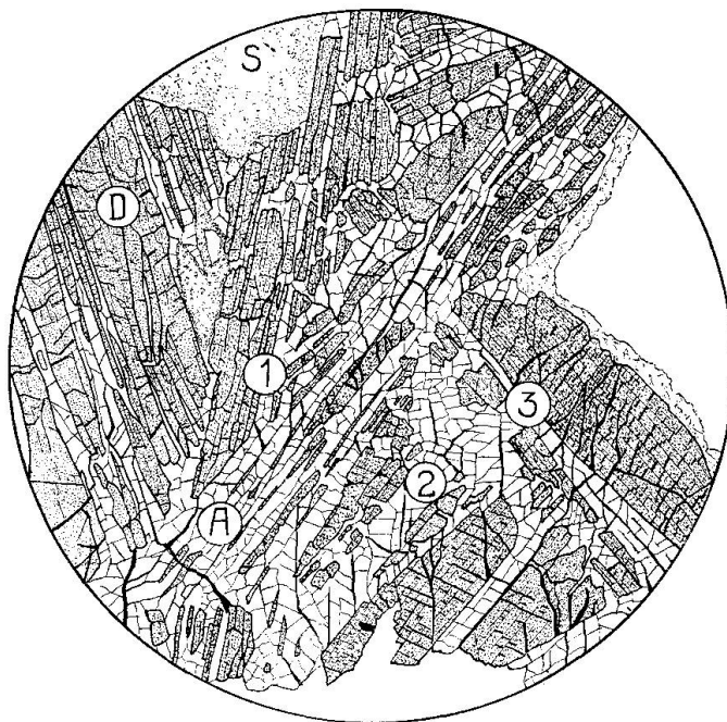
Fig. 6. Dünnschliff einer Verwachsung von Andalusit und Disthen. A = Andalusit, D = Disthen, S = Sericit. Die Lamellensysteme 1, 2 und 3 wurden mit dem Fedorofftisch untersucht (siehe Tabelle auf Seite 336). Vergr. 15 \times .
