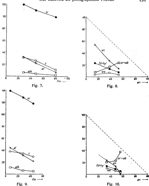
Fig. 7 und 9. Hauptgesteine von Potgietersrust (Fig. 7) und der Hauptzone (Fig. 9). Analoges Differentiationsdiagramm wie Fig. 1. si, c, al, alk gegenüber fm abgetragen. c ist zum Teil deutlich grösser; al, si und alk besitzen im allgemeinen höhere Werte als in Fig. 1.
