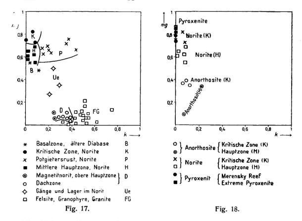
Fig. 17. k—mg-Diagramm. Die Norite des eigentlichen Noritkörpers zeigen hohes mg. Hinsichtlich mg sind mit den "red rocks" bereits nahe verwandt die Gesteine der Magnetitlager und der Dachzone. Gänge und Lager im Norit vermitteln zwischen ihnen und den gewöhnlichen Noriten. Man beachte auch die höheren k-Zahlen des Potgietersrust-distriktes.
