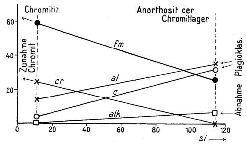
Fig. 3. Differentiationsdiagramm Anorthosit-Chromitit. Gegensätzliches Verhalten von cr und al, gleichsinniges Verhalten von cr und fm einerseits, al und c andererseits. si-Werte auf der Abszissenachse.
