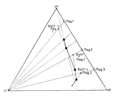
Fig. 25. Schematischer Verlauf der Kristallisationsbahn bei längerer Zeit gleichartiger Ausscheidung von Gemengen von Plagioklas + Biotit.
