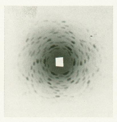
$Fig.~2.\\ Laue-Aufnahme~an~Ca_5NH_4(NO_3)_{11}~.~10~H_2O,~senkrecht~(0001).\\ Cu-K-Strahlung~+~Bremsspektrum~(50~KV).~Unter~Schellack.$
