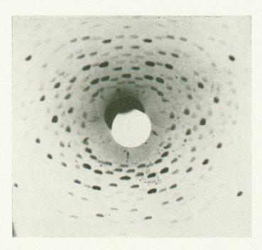
Fig. 1. Laue-Aufnahme an  $CaNH_4(NO_3)_3$ , senkrecht (100). W-Strahlung.
