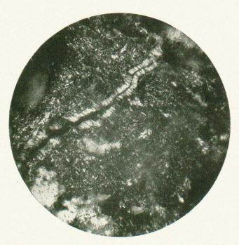
Fig. 1 (388) Nikols ×, Vergrößerung 220 ×, Neubildung (383) Nikols ×, Vergrößerung 115 ×, Neubildung von Sericit in unfrischem Injektionsgneis. Vgl. S. 74
