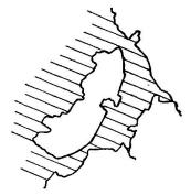
Fig. 9. Korrodierter Quarz in Calcit. Brisisandstein, Steinbruch Grabs.
