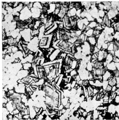
Fig. 10. Kalksandstein mit beginnender Verwitterung. Sehr deutlich treten die Kalzit rhomboeder durch die Limonitumrandung sowie das Eindringen des Limonits auf Spaltflächen hervor. Steinbruch Sevelen. Vergr. ca. 30\times
