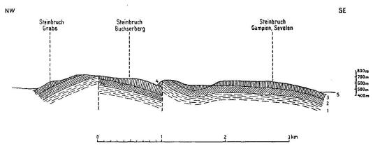
Fig. 4. Querprofil durch das Rheintalvorkommen. 1 = Drusbergschichten, 2 = oberer Schrattenkalk, 3 = mittlere Kreide, 4 = Seewerkalk, 5 = Alluvium.
