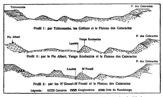
Fig. 2. Profils à travers la région de la rive gauche du Niari
