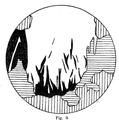
Liveingit verdrängt durch Baumhauerit. Liveingit: weiss, Baumhauerit: schwarz, Skleroklas: quer gestreift, Dolomit: vertikal gestreift. Geätzter Anschliff.
