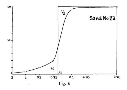
dass  $V_1 = V_2$  und der Inhalt dieser Flächenstücke umso geringer sein muss, je näher der in Frage stehende Sand einem "idealen" Sand steht
