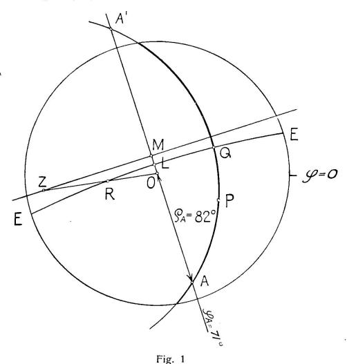
E — E. Alle Kanten, deren stereographische Projektionen auf den Grosskreis APA' fallen, werden ebenfalls nach Q projiziert. Der Meridian APA' ist somit eine der gesuchten Kurven gleicher Kantenneigung.
