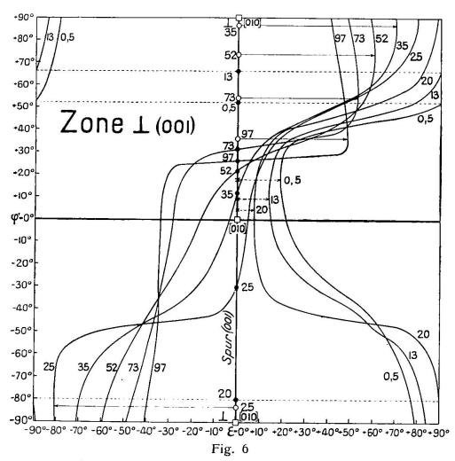
Zone  $\perp$  (001). Zonenauslöschungskurven der acht Plagioklastypen. Ordinaten: Richtungen in (001), Abszissen: Auslöschungsschiefen  $\varepsilon$  von n'a zur Spur von (001). Die Signaturen  $\bullet$   $\bigcirc$  × wie in Fig. 2.
