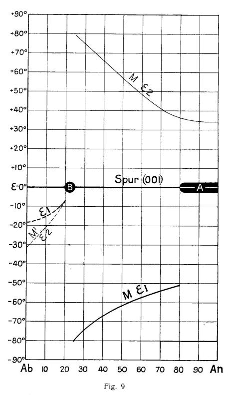
Zone  $\lfloor (001)$ . Extreme Werte der Auslöschungsschiefen  $\varepsilon$  von n'a zur Spur von (001). M= maximale, M'= minimale Auslöschungsschiefe.  $M_2$  und  $M'_2=$  konjugierte Werte im Aklinzwilling. A und B= optische Achsen. Ordinaten: Auslöschungsschiefe, Abszissen: Anorthitgehalt.
