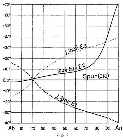
Zone  $\bot$  (010). Auslöschungsschiefen  $\varepsilon$  von n'u zur Spur von (010) in den Richtungen [001] = Achse des Karlsbader Gesetzes und  $\bot$  [001] = Achse des Albit-Karlsbad-Komplexes.
