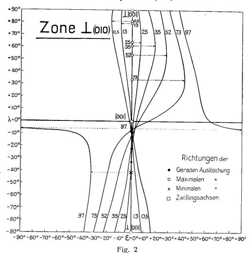
Zone  $\perp$  (010). Zonenauslöschungskurven der acht Plagioklastypen. Ordinaten: Richtungen in (010), Abszissen: Auslöschungsschiefen  $\varepsilon$  von N<sup>c</sup>a zur Spur von (010). Die Zahlen 97, 73, 52 etc. bedeuten Anorthit  $^{0}/_{0}$ .
