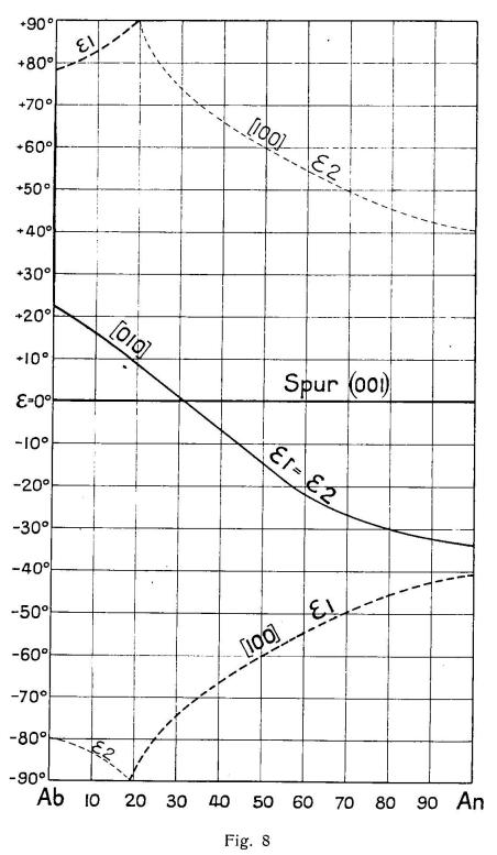
Zone 100 (001). Auslöschungsschiefen  $\epsilon$  von n'a zur Spur von (001) in den Richtungen [100] = Spur der Spaltrisse nach (010) oder der Albitlamellen, [010] = Achse des Aklingesetzes.
