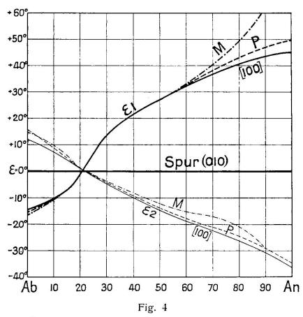
Zone  $\perp$  (010). Auslöschungsschiefen  $\ell$  von n'a zur Spur von (010) in den Richtungen [100] = Spur der Spaltrisse nach (001) in (010), P = Spur der Periklinverwachsungsebene und M = maximalen Auslöschungsschiefe.
