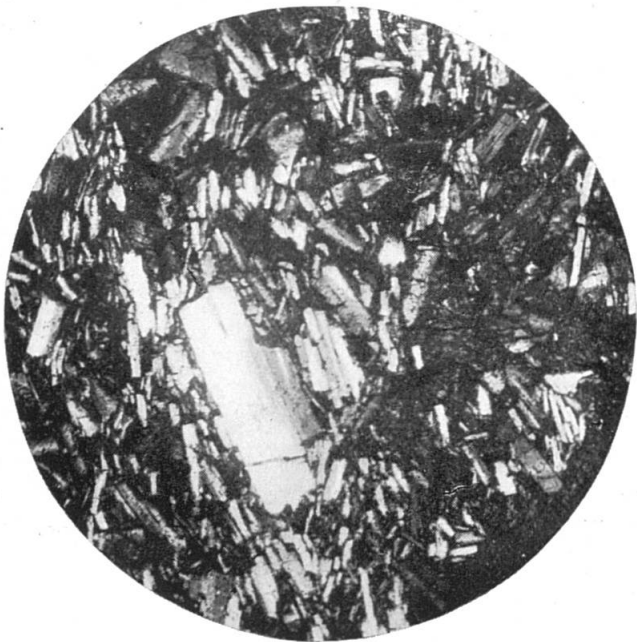
Fig. III (Hohen Faulen, Uri). Ergußgestein mit trachytähnlicher Struktur. Vergr. 40 fach.
