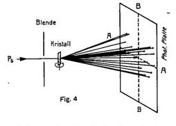
Schema der Drehkristallmethode. A—A und B—B sind die Symmetrielinien jeder Drehaufnahme.)
