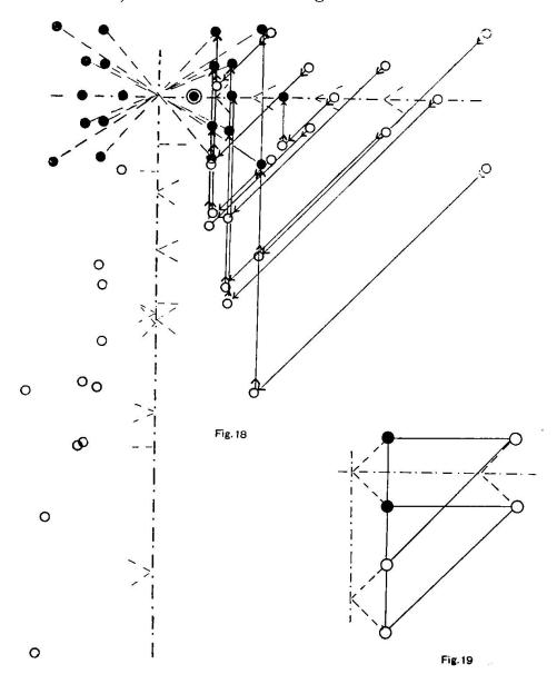
Schema der Kombination einer Drehkristallaufnahme in der Richtung I mit einer Aufnahme in der Richtung II. Die vollen Kreise geben die Reflexe einer entsprechenden ruhenden Aufnahme wieder. Konstruktion der ruhenden Aufnahme aus zwei in verschiedenen Richtungen mit gleicher Geschwindigkeit aufgenommenen, bewegten Drehkristallaufnahmen. Ermittlung von  $\alpha$  und  $\delta$ .
