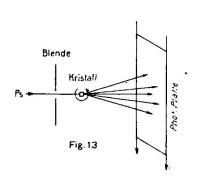
Schema einer bewegten Drehkristallaufnahme in der Richtung I.
