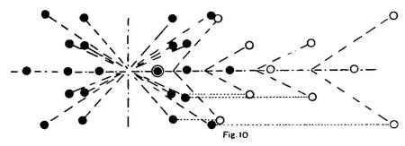
Schematische Wiedergabe eines bewegten Drehkristalldiagrammes in der Richtung I. Zur Übersicht ist ein vollständiges ruhendes Diagramm eingezeichnet, dessen Reflexe durch volle Kreise gekennzeichnet sind. Von der bewegten Drehaufnahme ist nur die rechte Hälfte gezeichnet. Der Ausgangspunkt der Drehung ist durch den Reflex angezeigt, wo ein voller Kreis von einem leeren umgeben wird. Die punktierten Linien geben die Zuordnung der Reflexe an.
