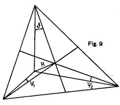
Erweiterte Darstellung der Fig. 7 mit den Normalenwinkeln zur a-, b- und c-Achse  $(\vartheta, \psi_1 \text{ und } \psi_2)$ .
