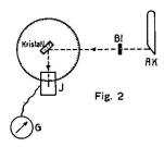
Schema der Methode nach Bragg. (AK: Antikathode; Bl.: Bleibende; J: Ionisationskammer, G: Galvanometer.)
