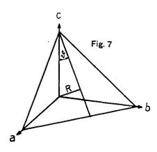
Kristallographisches Achsenkreuz (a, b, c: die krist. Achsen) mit einer eingezeichneten Fläche (h k l) und dem dazu gehörig. Flächenlot (R). ( $\vartheta$  ist der Neigungswinkel der Normalfläche zu R zur c-Achse).
