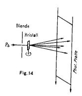
Schema einer bewegten Drehkristallaufnahme in der Richtung II.
