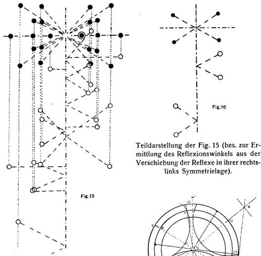
Schema eines bewegten Drehkristalldiagrammes in Richtung II. Zur Übersicht ist ein ruhendes Diagramm (mit vollen Kreisen als Reflexe) eingezeichnet. Die punktierten und gestrichelten Linien dienen zur Orientierung.
