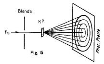
Schema der Methode nach Hull (KP: Kristallpulver).
