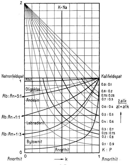
Fig. 1. k,  $\frac{2 \text{ alk}}{\text{al} + \text{alk}}$  — Diagramm
