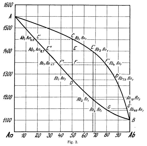
Die abgeschiedenen Kristalle werden sich dann durch Saigerung vollkommen von der Schmelze trennen und werden so der Diffusion saurerer Moleküle entzogen. Kehren wir zu unserer Schmelze Ab<sub>1</sub> An<sub>1</sub> zurück und lassen sie bis zum Punkte F (1340°) abkühlen, so sehen wir, daß der bis dahin abgeschiedene Feldspat die Zusammensetzung F'' aufweist, also einem Labradorit Ab<sub>1</sub> An<sub>17</sub> entspricht. Die in diesem Augenblick noch vorhandene Schmelze hat
